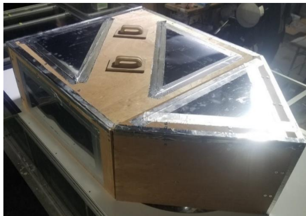
Fig. 3.25 広島大学回流式風洞での GLOF 実験における気流除け
