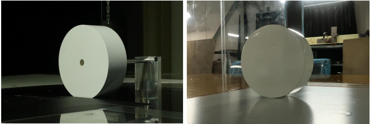
Fig. 6.4 接地状況の異なる非回転単独タイヤのセットアップ (左) 広島大学回流式風洞 (右) 九州大学応用力学研究所大型境界層風洞
