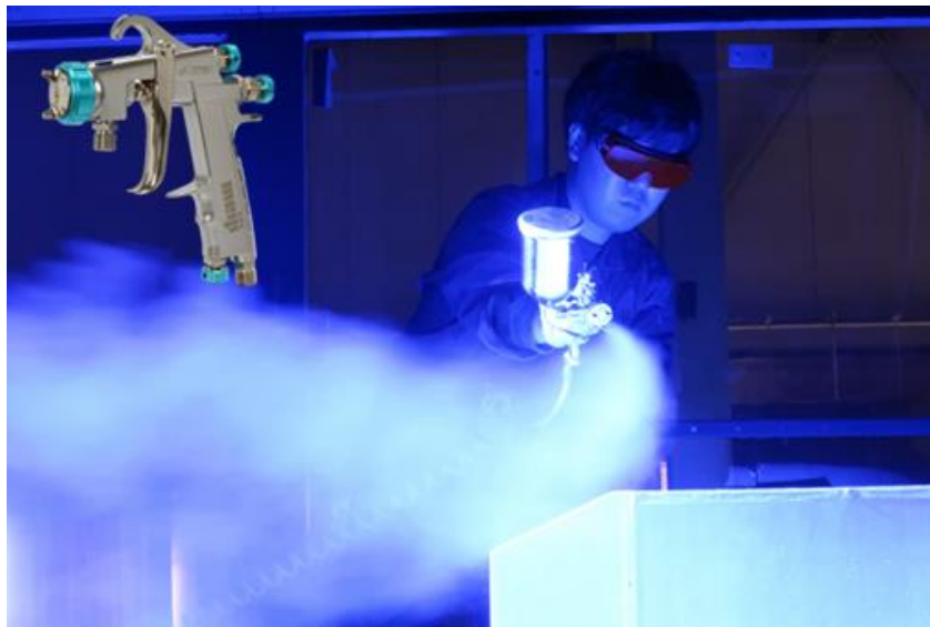
Fig. 3.31 自動車補修用スプレーガンによる塗装
