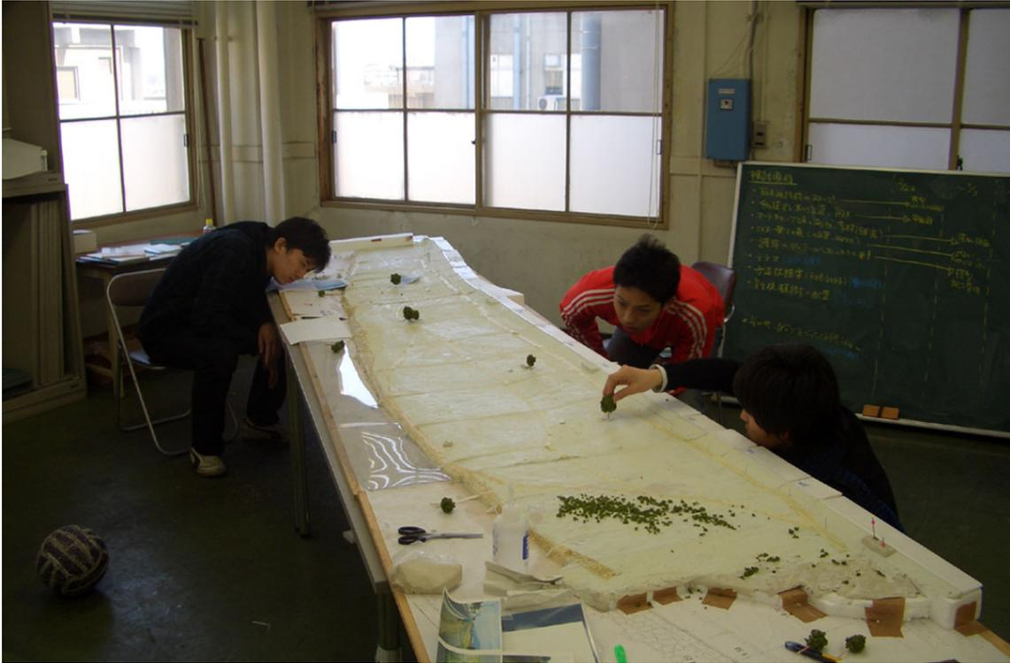
図-15 左岸のデザイン検討模型（縮尺 200 分の 1）
