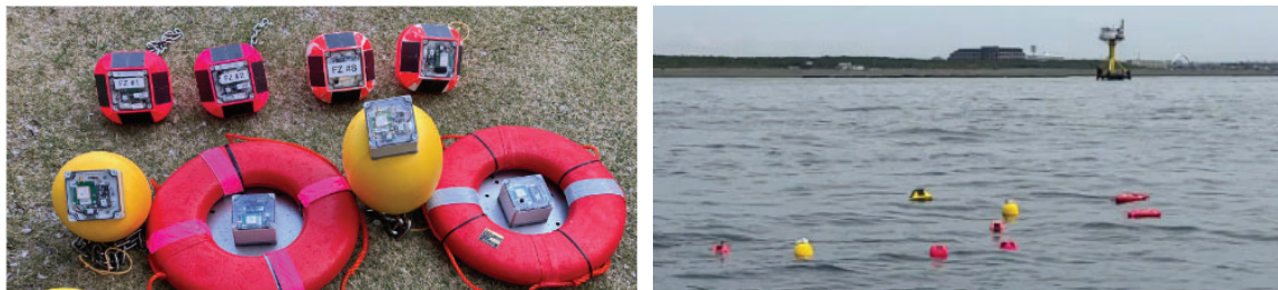
Fig. 1 波浪計測試験に利用した各種機器(左)と展開の様子(右)
