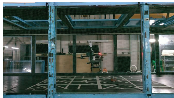
図2 境界層風洞による実験の様子
