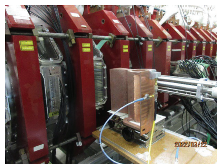
図 1: フェーズドアレイアンテナを PANTA 装置に設置
