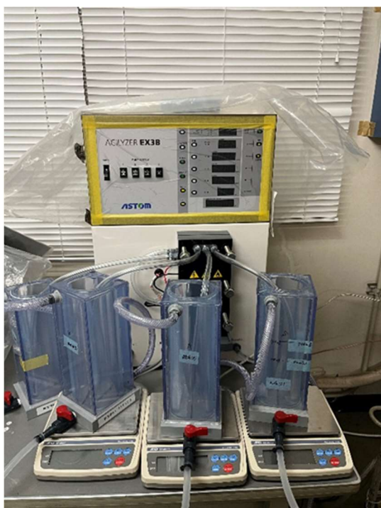
図 4.7.各室の下に設置された電子天秤と各室にかかっているホース。
