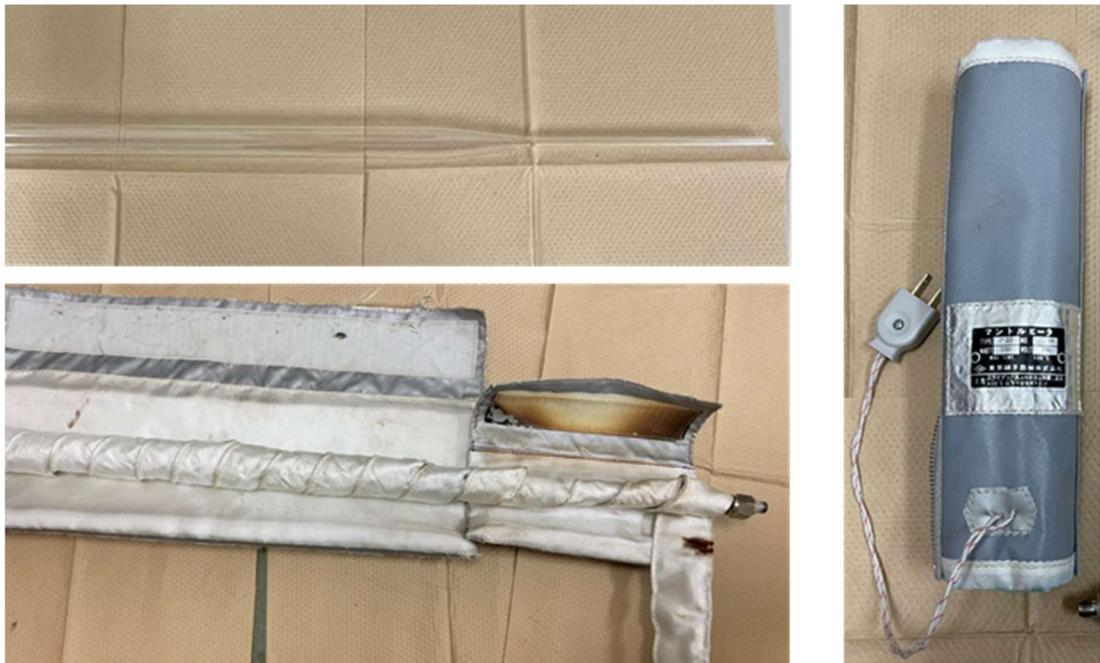
図 4.5 本研究で使した固定床管型反応器と保温方法
