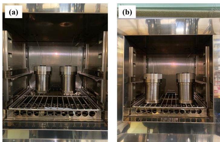
Fig.4.3 温度計測時の外筒設置場所 (a)定温乾燥機奥側、(b)定温乾燥機手前側
