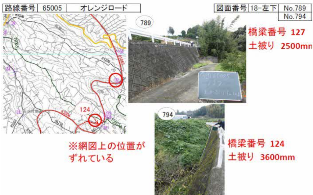
図－2.7 土被り 1m 以上の市道橋の発見事例
