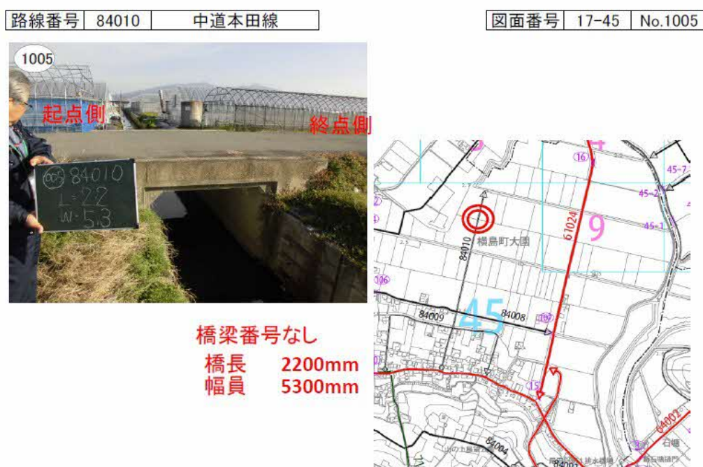
図－2.5 市道網図に表記のない市道橋の発見事例
