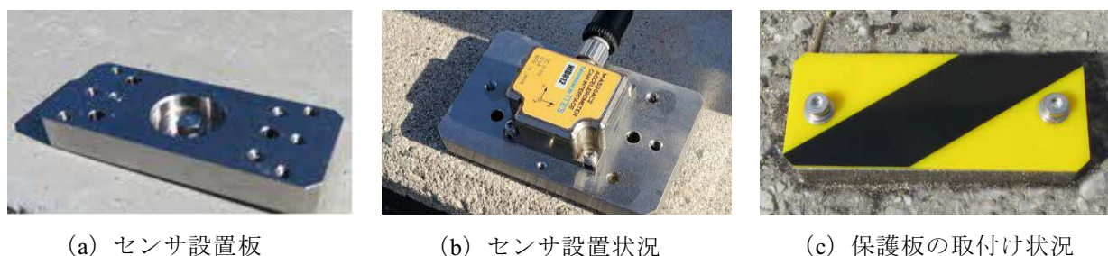
図－6.5 小島橋に設置するセンサ設置板
