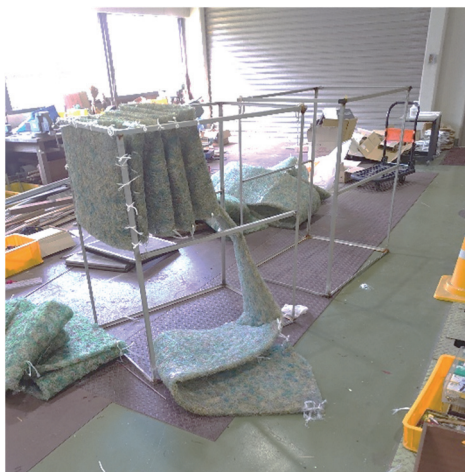
図2 消波マット張替えの様子
