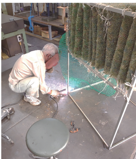
図3 フレーム溶接時の様子
