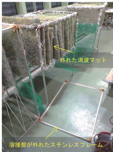
図 1 壊れた消波装置
