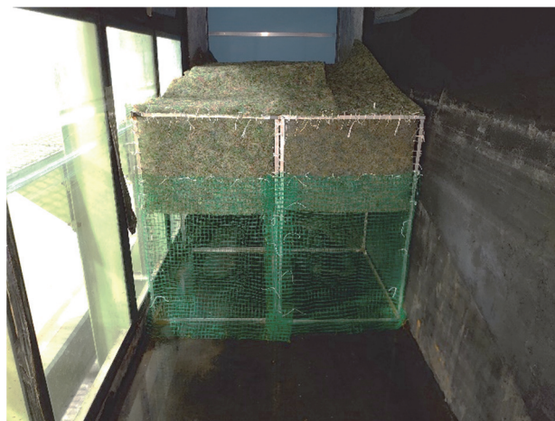
図4 再設置した消波装置
