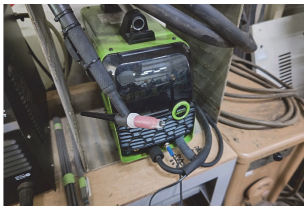
図3 使用したTIG溶接機
