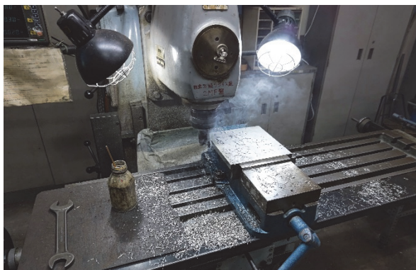
図2 フライス盤による外形切削加工中の様子
