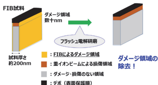
図 1 フラッシュ電解研磨によるダメージの除去
