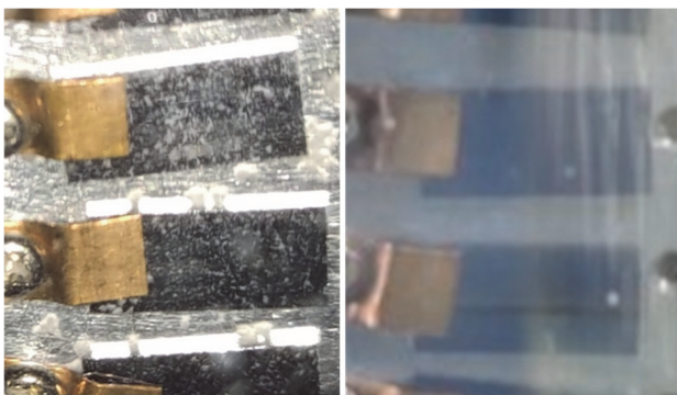
図2 液体窒素注入時の試料の様子 (左) 装置稼働直後 (右) 対策実施後
