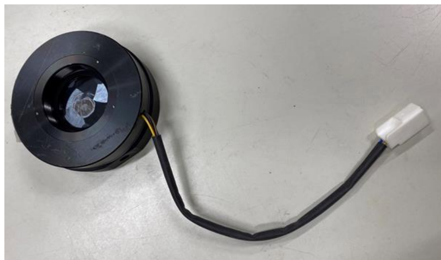
図 3. 9 シャッターの外観
