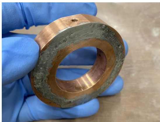
図 4.5 タンク放電室の外観
