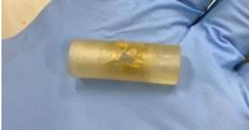
図 2. 16 加熱により割れたノズル
