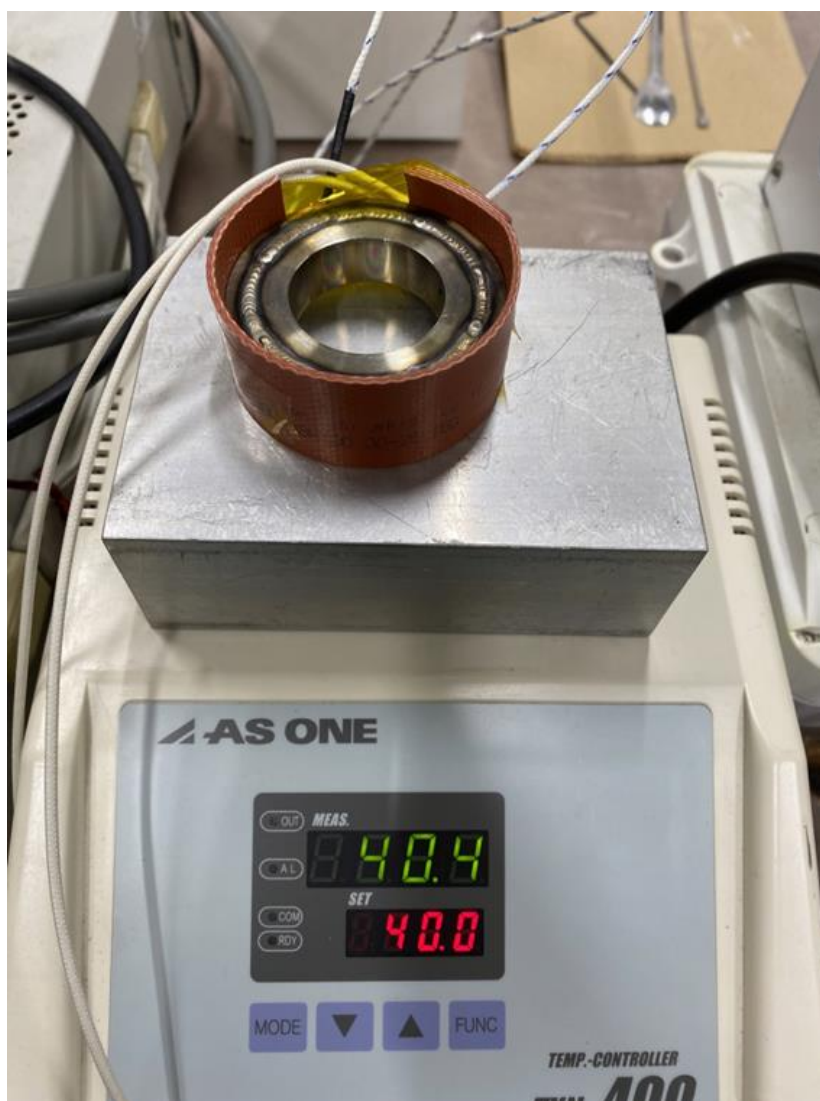
図 4.7 温度調節器によるタンク温度の制御
