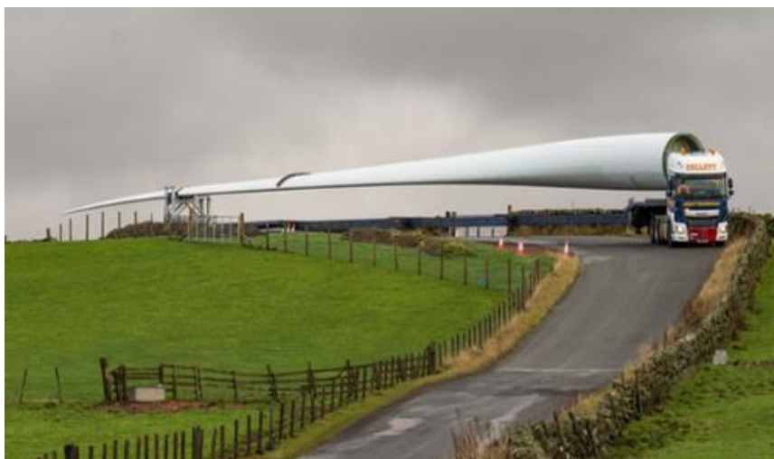
図 1.9 ブレード運搬時の様子
