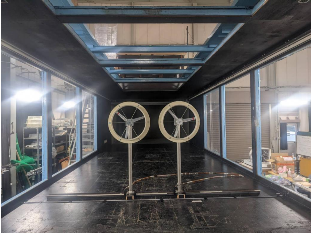
図 4.5 2 基レンズ風車出力性能試験概観図( s/D_{brim}=0.2 )
