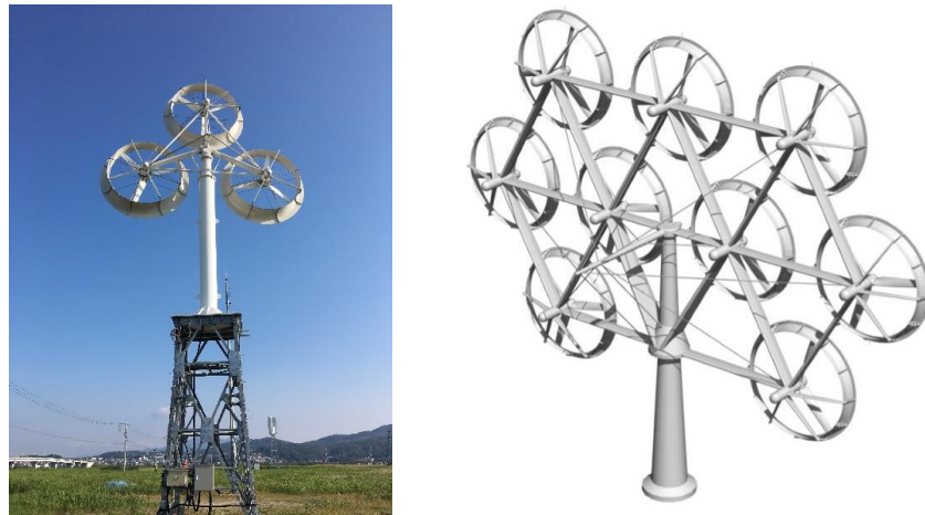
図 1.15 マルチレンズ風車(左：9KW マルチレンズ風車 右：9 基構想図)
