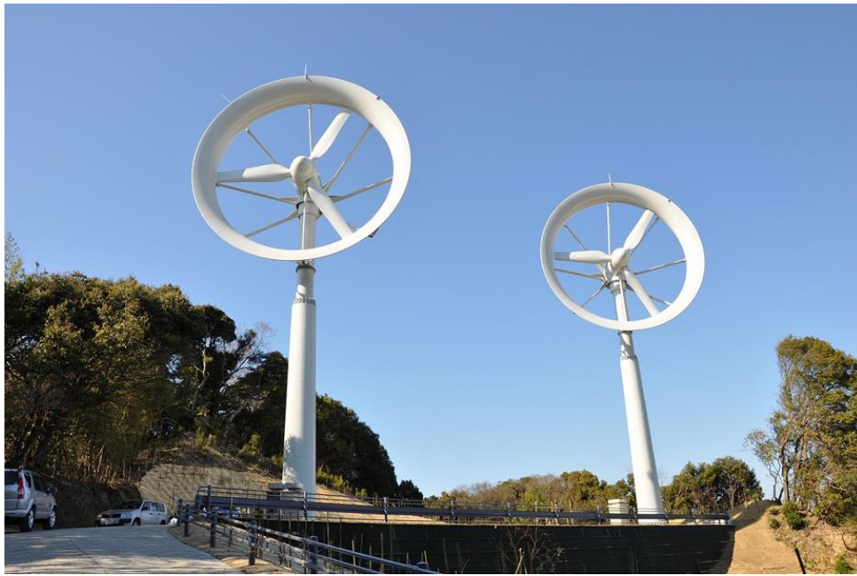
図 1.13 100kW レンズ風車
