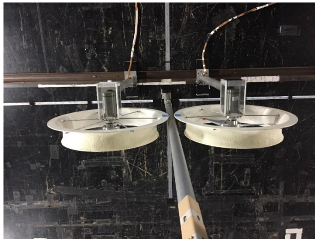
図 4.27 ポールを配置した際の 2 基レンズ風車の出力性能試験概観図
