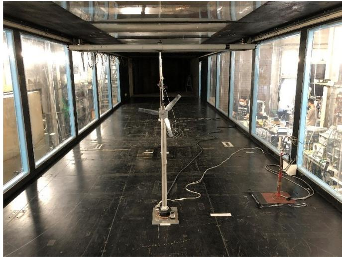
図 B.8 ブラフボディの影響がないデータとして参考にした風車模型の配置図
