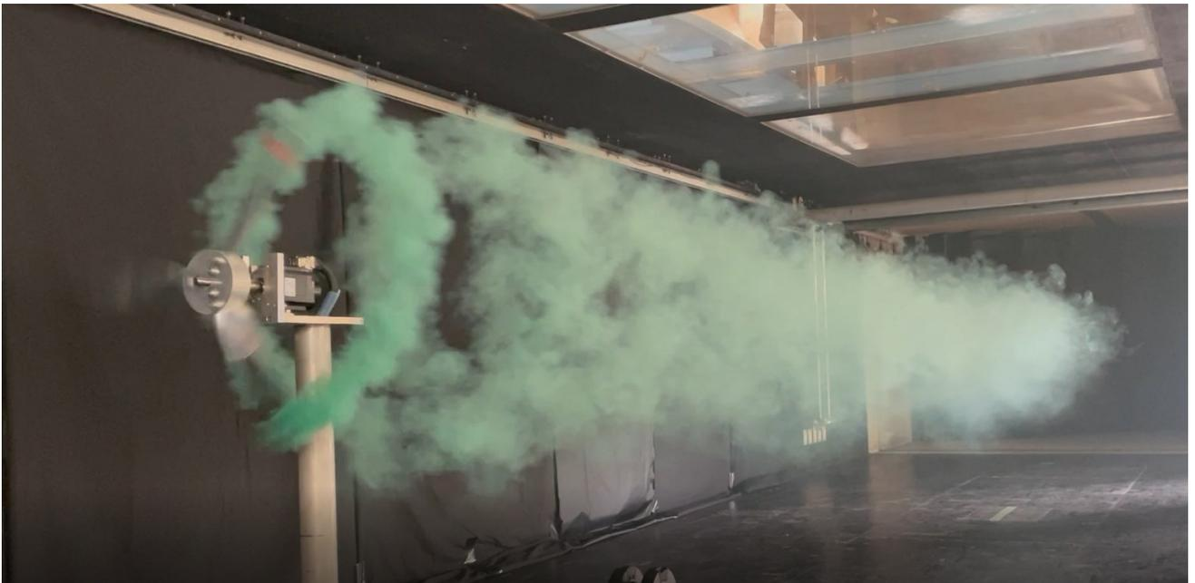
図 4.7 スモークケーキを用いた動揺なし状態の可視化実験結果（斜め前方視点）
