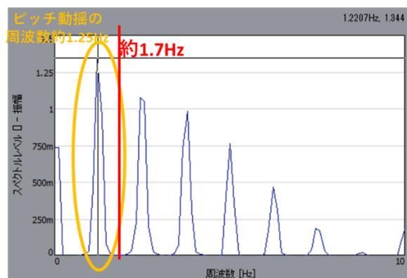
図 A.4 回転計から出力された電圧の時系列データに対して周波数解析を行った結果
