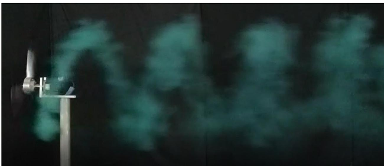
図 4.9 スモークケーキを用いた動揺なし状態の可視化実験結果（真横視点）
