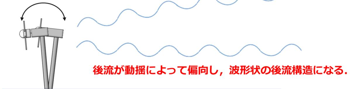
図 5.10 ピッチ動揺状態の後流構造のイメージ
