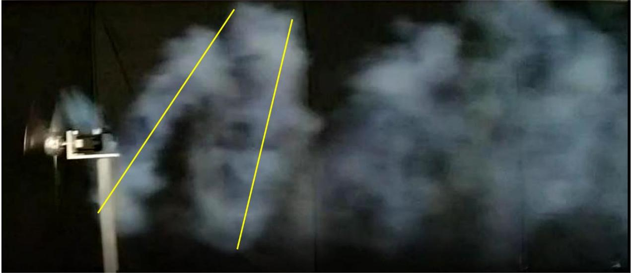
図 4.10 スモークケーキを用いたピッチ動揺 $\pm 5[\text{deg}]$ 状態の可視化実験結果（真横視点）
