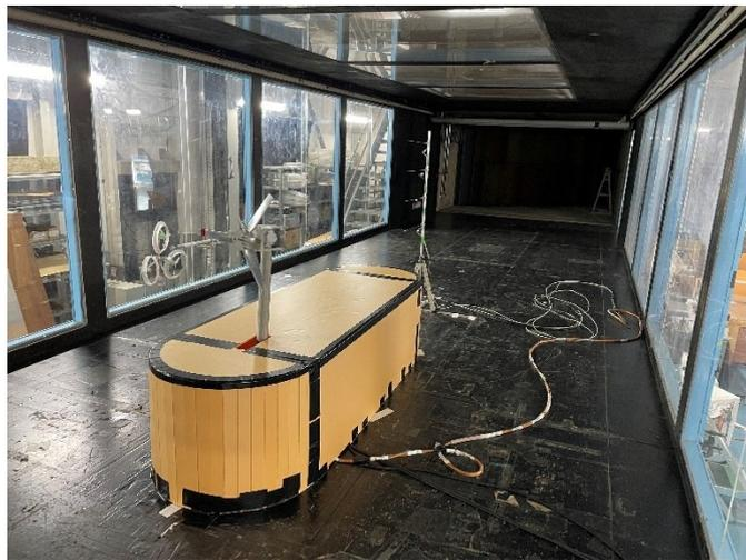
図 B.7 製作したカバーを加振装置に装着した様子
