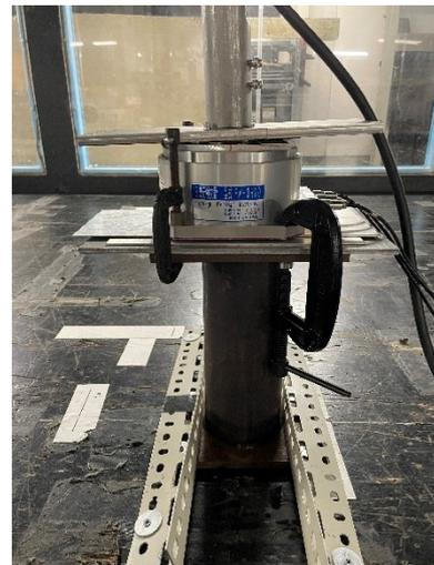
(ii)風車模型下に設置した検力計
