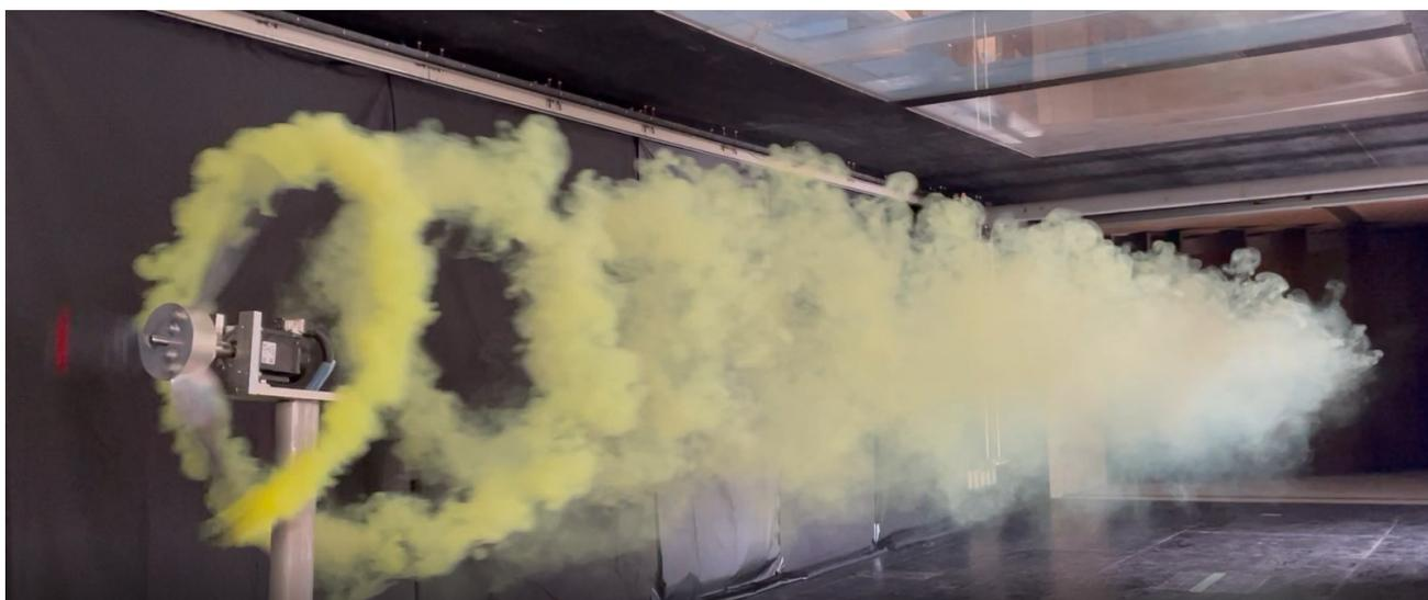
図 4.8 スモークケーキを用いたピッチ動揺 $\pm 5[\text{deg}]$ 状態の可視化実験結果（斜め前方視点）
