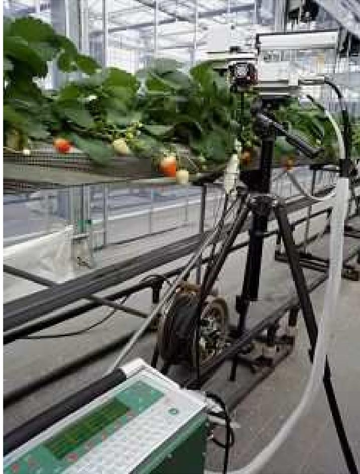
図2-2 ハウス内における光合成速度測定の様子
