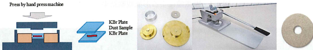
図4-2 KBr プレート法概略図，サンプル作成治具（2点），測定用サンプル
