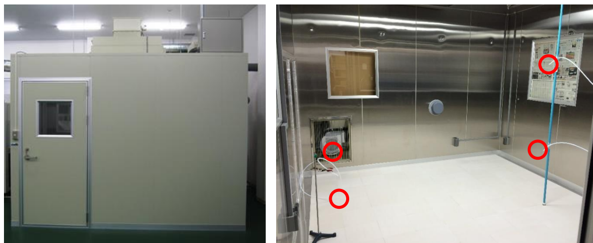
図-2.13 大形チャンバー概要及び測定点
