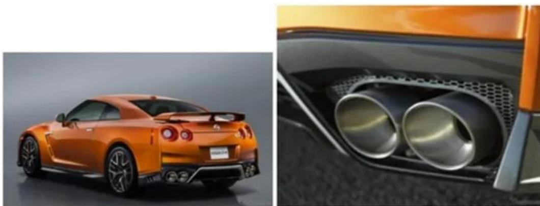
Fig. 1-2 日産自動車株式会社製 GT-R EGO-IST に使用されているチタン合金[11]
