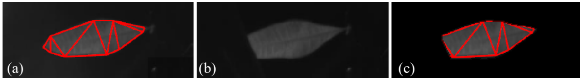
図 32 (a) 葉の初期状態, (b) 遮蔽された際の入力画像, (c) (b)を2値化した画像で投影内容をマスクした結果.
