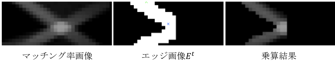
図 29 マッチング率画像とエッジ画像 E^t の一部の乗算
