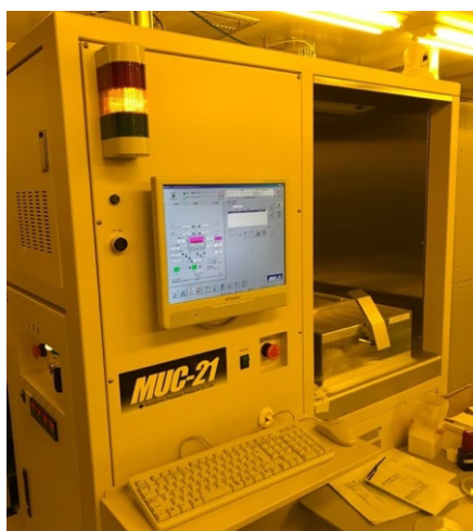
図 3.10 使用した ICP 装置（住友精密工業社製，MUC-21 ASE-SRE）
