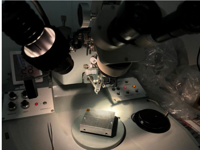
図 3.14 使用したボンディングマシン（超音波工業社製 ULTRASONIC WIRE BONDER）
