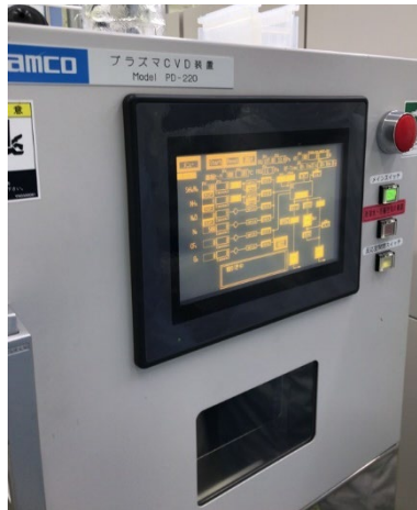
図 3.3 窒化シリコンの成膜に用いたプラズマ CVD 装置
