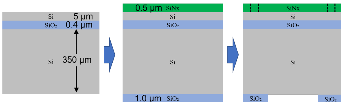
図 3.4 SOI 基板への成膜とアライメント形成の断面模式図
