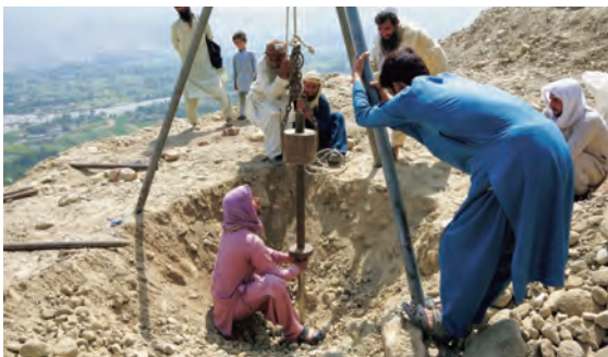
日本の技術支援チームからのアドバイスで、工事に先駆け地盤の支持力検査を行なった。堆積土からなる急勾配の崖地に水路を建設するため、安全面には最大限の注意が必要。(2022年9月20日)
