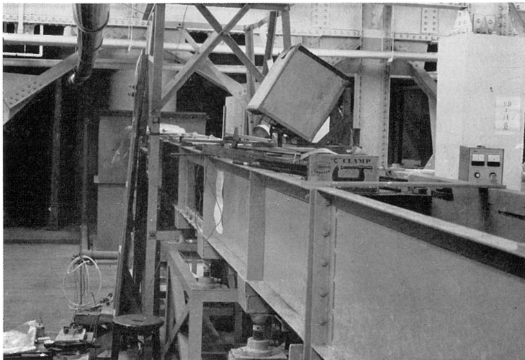
写真5 回流型開水路
