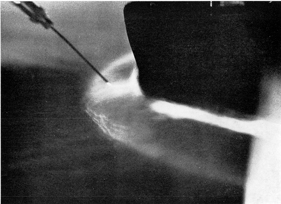
写真2 南星丸模型船の船首付近における船首くび飾り渦の構造
