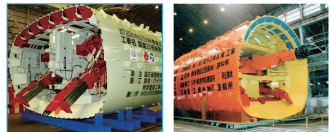
(a) 敞开式矩形掘进机 (b) 悬臂式掘进机
