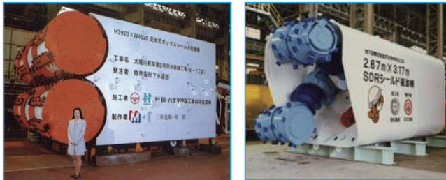
(a) 泥水平衡掘进机 (b) 土压平衡掘进机
