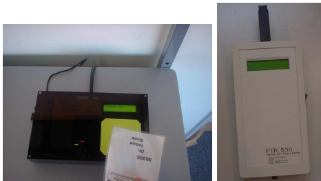
図1: ネームプレートとリーダ, および携帯型リーダ
