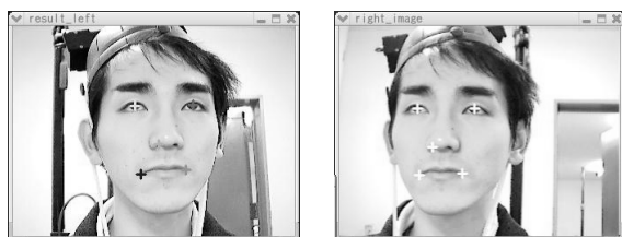
(a) 左画像上の特徴点 (b) 右画像上の特徴点 図 3: 特徴点検出実験結果
