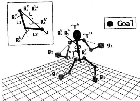
図 2: 人体モデルの構造およびゴール方向の定義
