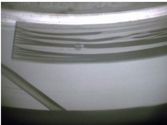
e) Time : 600sec, Cavitation pressure:91kPa(abs.)
