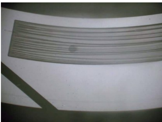
e) Time : 600sec, Cavitation pressure : 69kPa(abs.)
