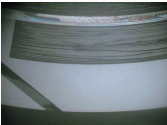
e) Time : 600sec, Cavitation pressure : 85kPa(abs.)
