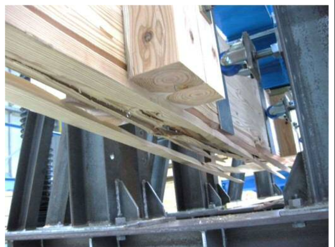
GBM12x3 No.⑧／破壊性状分類 B2
