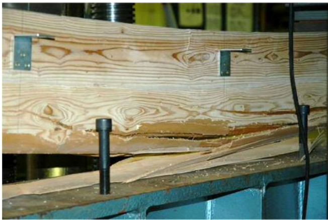
GBM12x2 No. ③／破壊性状分類 B1
