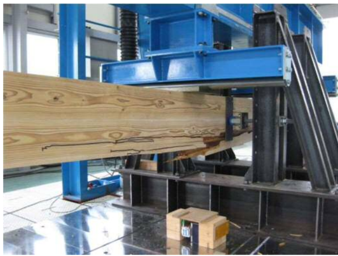
GBM15x2 No.⑨／破壊性状分類 A
