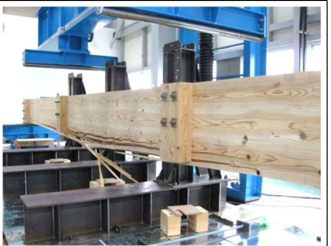
GBM15x3 No.②／破壊性状分類 B2
