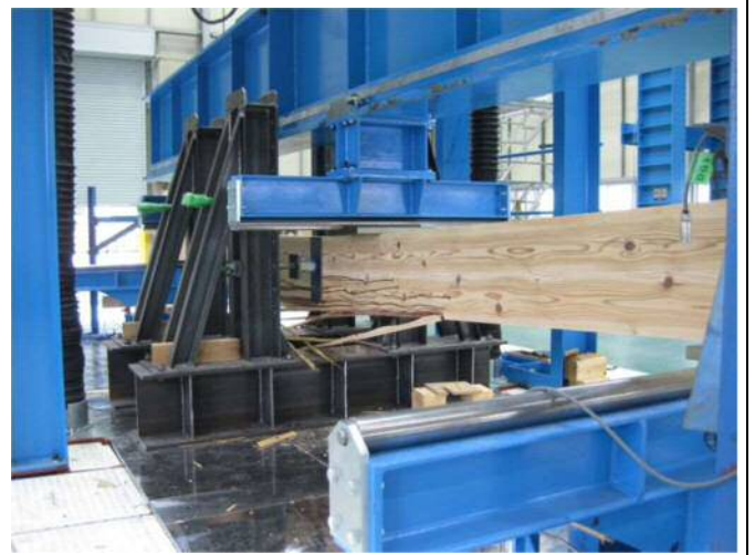
GBM15x2 No.⑩／破壊性状分類 B1
