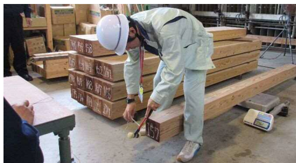
写真 8.1 縦振動法によるヤング係数の測定
