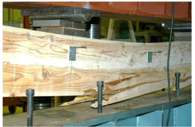
GBM12x2 No. ④／破壊性状分類 B1
