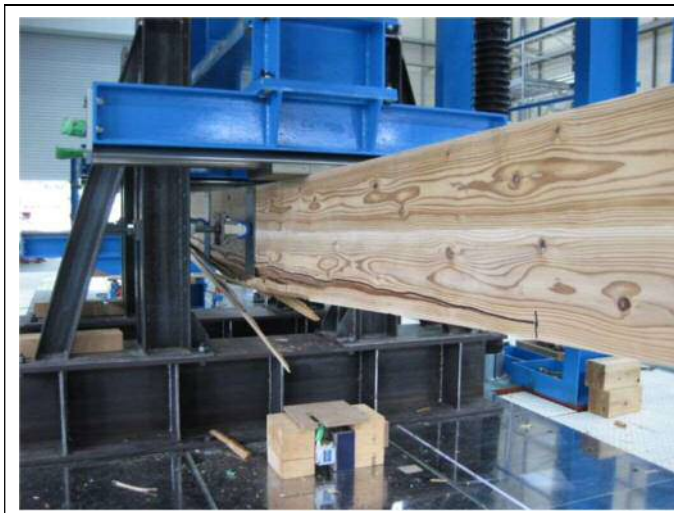
GBM15x2 No.⑦／破壊性状分類 B2
