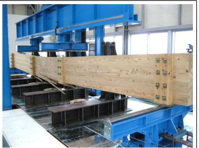
GBM15x4 No.②／破壊性状分類 B2
