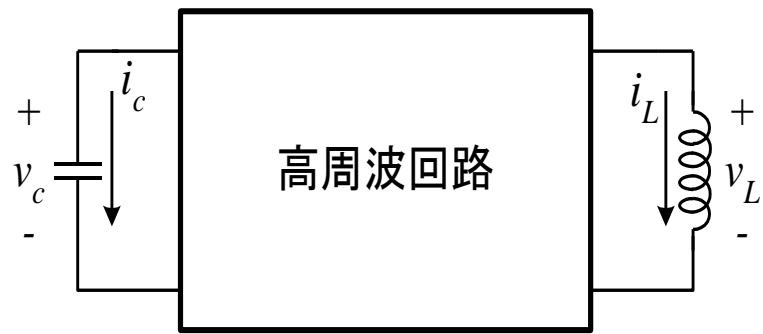
図 9.9 軟性フライバックコンバータの構成図
