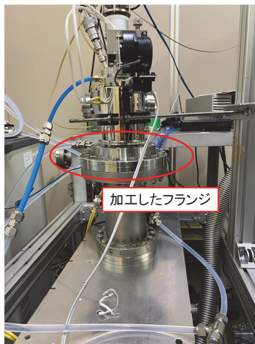
図 1 加工後のフランジを設置した予備実験用チャンバー
