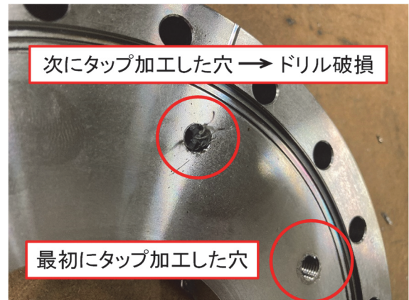
図10 タップ加工時にドリルが破損した穴
