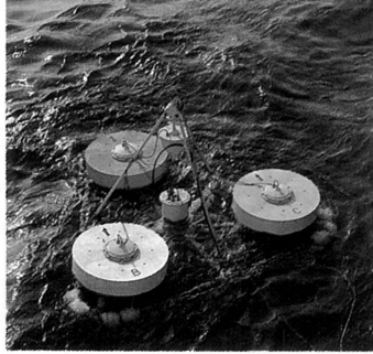
図-3 クローバー型波浪計 (光易 他 1973) 中央部上方マグネットコンパス, 下方鉛直ジャイロと加速度計
