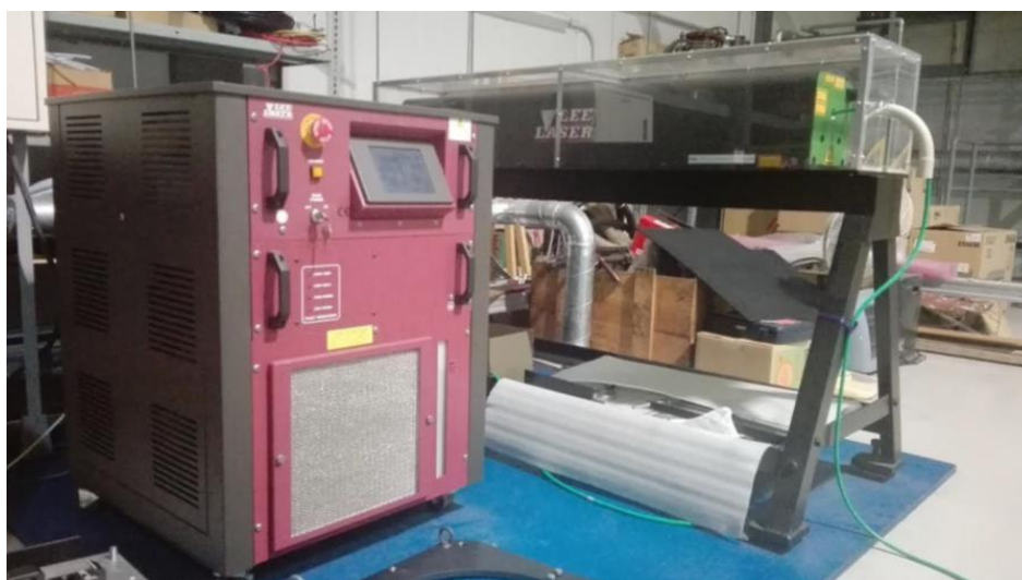
図 3.17 Lee Laser 社製 LDP-100MQG の外観 (左；電源・冷却水ポンプユニット、右；レーザーヘッド)
