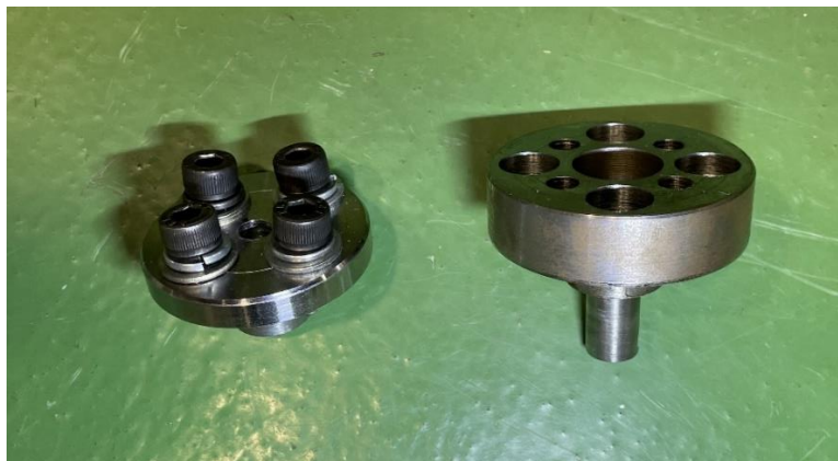
図 3.3 シート光を入れるための部品（左：上部、右：下部）
