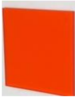
図 3.15 蛍光 PIV 計測で用いられたシャープカットフィルターの外観
