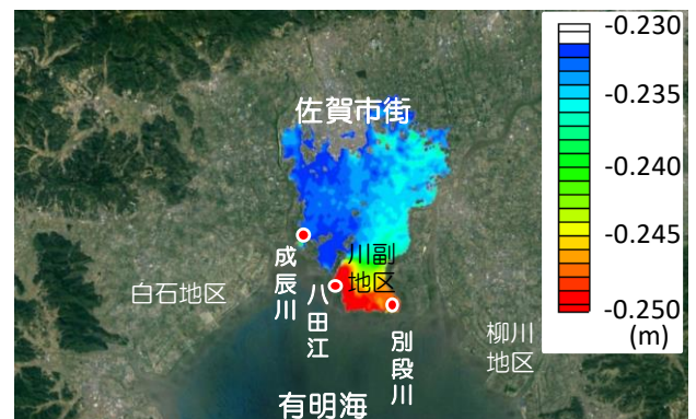
図 3-12 浸水深の差 (排水ポンプ有り - 無し)
