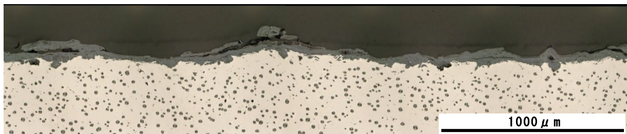
図 5-13 照明柱下部のさび層断面
