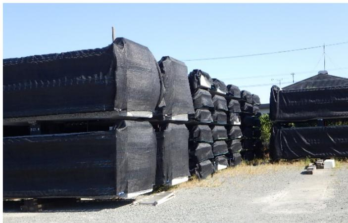
写真-6.3 遮光ネットによる紫外線劣化対策の例
