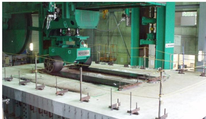
写真-2.1 輪荷重走行疲労試験<sup>14)</sup>
