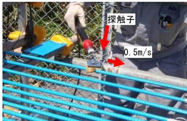
写真-6.8 ピンホール試験状況
