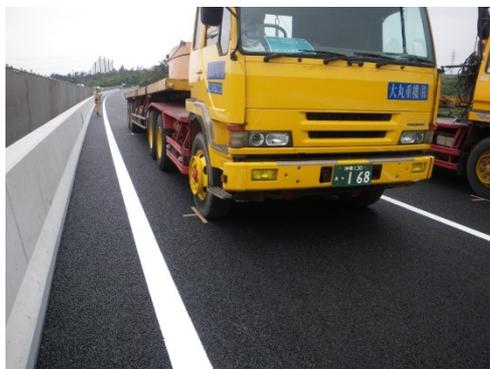
写真-4.1 静的載荷試験状況
