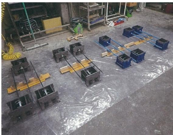
(a) 鉄筋付着試験体作製状況
