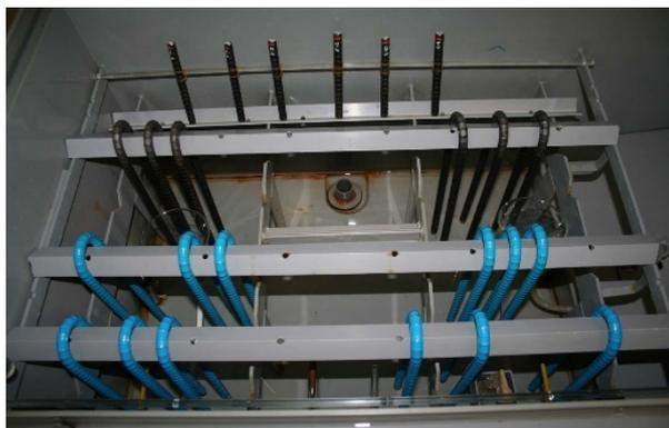
写真-6.12 塩水噴霧装置内の鉄筋配置状況
