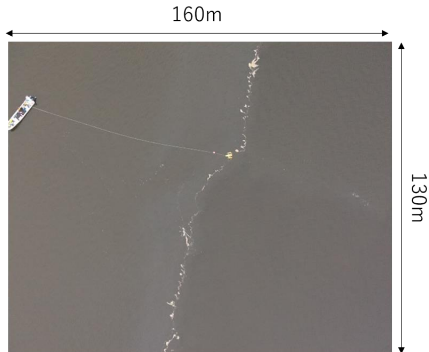
図 4.1.8 厚岸湾の河口で撮影した可視画像である。縦方向に伸びる河川フロントによる泡列が確認できる。左側には曳航用のボート、中央には水上ドローンが写っている。
