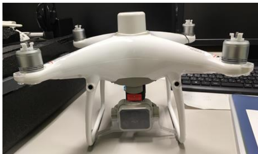
図 2.1 空撮ドローン(P4 Multispectral)。可視カメラ 1 台とマルチスペクトルカメラ 5 台が搭載されている。
