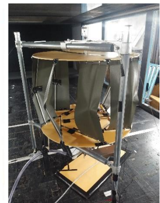
図1 実験に用いたローテーション・フロー風車の基本形状の断面図（左）、ならびに実験時の風車仕様の一例（右）。
