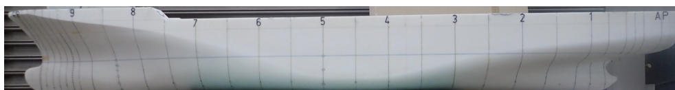
Fig. 1: RIOS container model(ウレタン製, 船側波形計測用)
