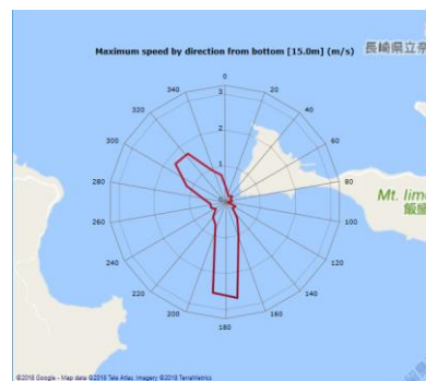
図1 奈留瀬戸における流速観測場所と水面下10mでの最大流速の流向
