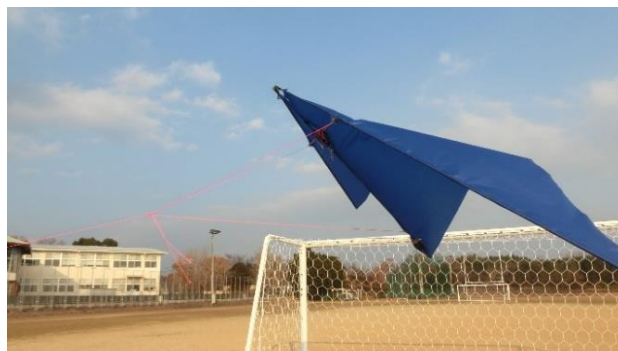
図5 カイトの飛行試験飛行(浮上機器無し)
