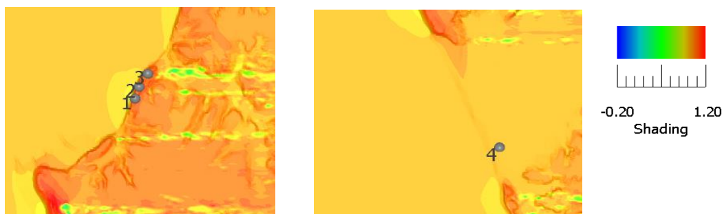
図 2 RIAM-COMPACT で再現した地上高 38m での U 方向の風速 (左：崖地形 右：平坦地形)
