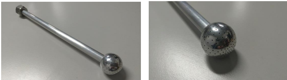
図 1 多孔ピトー型プローブの外観 (左) と球に設けられた静圧孔の様子 (右)
