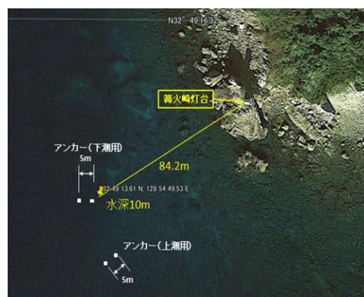
図2 アンカー設置位置と電力線敷設
