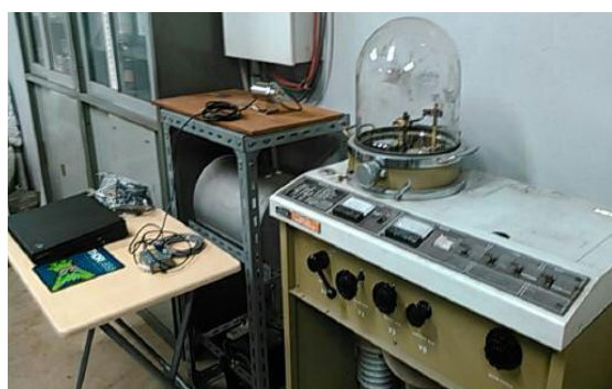
図 1 ベルジャー内加熱タングステン板の非接触温度測定装置
