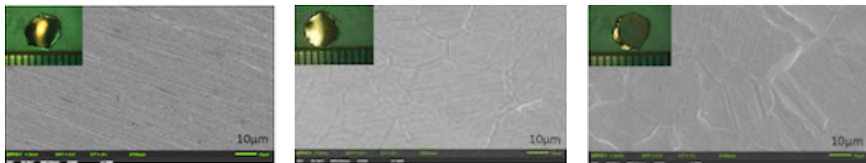
図3 SUS304 試料表面（左：研磨表面、中：1 h 注入、右：100 h 注入）
