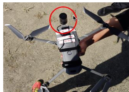
図1 受信機を搭載したドローン
