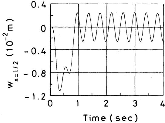
図4 一端単純支持・他端固定はりの応答計算結果(はりの中央点)
