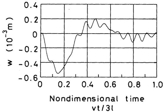
図6 3スパン連続はりの応答計算結果(第1スパン中央点)
