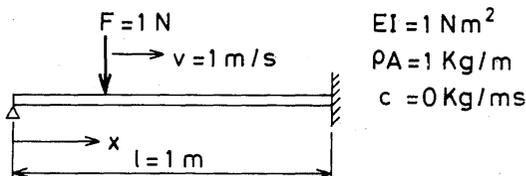
図3 移動荷重を受ける一端単純支持・他端固定はり
