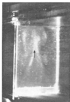
図17 一平板まわりに起る三次元流れ 主流に直角で, 平板を含む垂直断面 h=1.05 cm, w=0.105 cm, f=0.533 Hz, s=0.40 cm, \nu=0.0106 cm 2 /s, R_h=348 , R_s=50.5 , t_e=5 sec.
