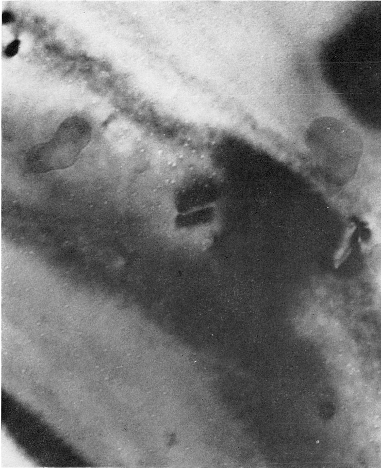
写真1 中性子照射されたニオブ中のボイド ( 9 \times 10^{20} \text{ n/cm}^2 , 450^\circ\text{C} , \times 156,000 )
