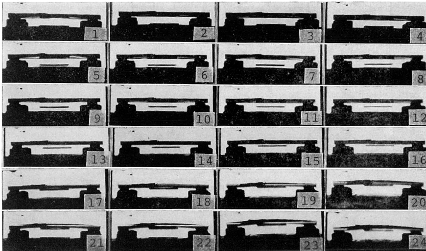
写真5 飛び板(銅板)の飛しょう姿勢
