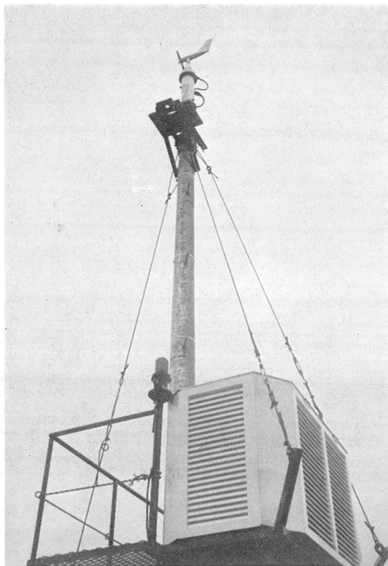
写真 5.5.7 百葉箱, マグネットコンパス, 及び風速計
