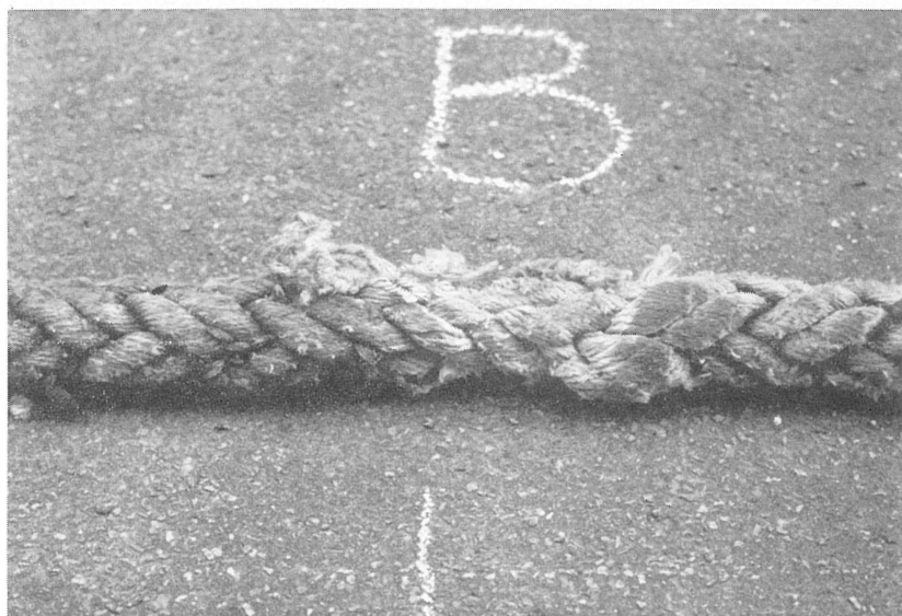
写真 5.6.3 ナイロンロープ損傷部 B
