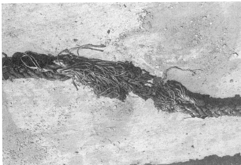
写真 5.6.2 (a) ナイロンロープ切断箇所
