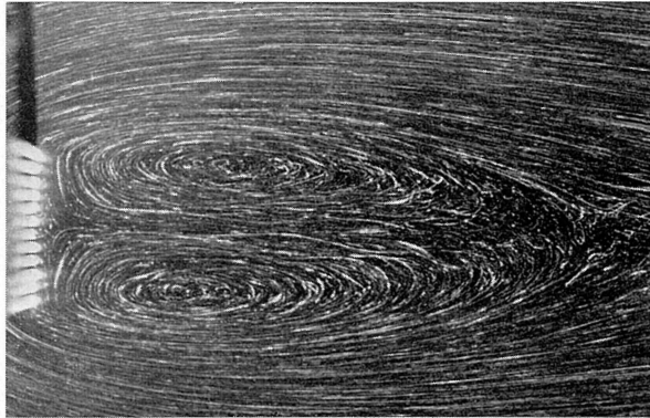
写真 4 l/d_o が小さいときの渦: d=1.41 cm, d_o=0.0810 cm, l/d_o=0.494 , U=0.210 cm/sec, R_s=1.85 , R_g=32.2
