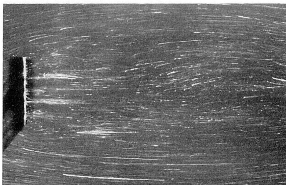
(b) 加速直後の流れ: U_2 = 1.04 \text{ cm/sec} , R_{g2} = 300 , 加速度 = 4.75 \text{ cm/sec}^2 , t = 2.50 \text{ sec} , U_2 t/d = 0.867
