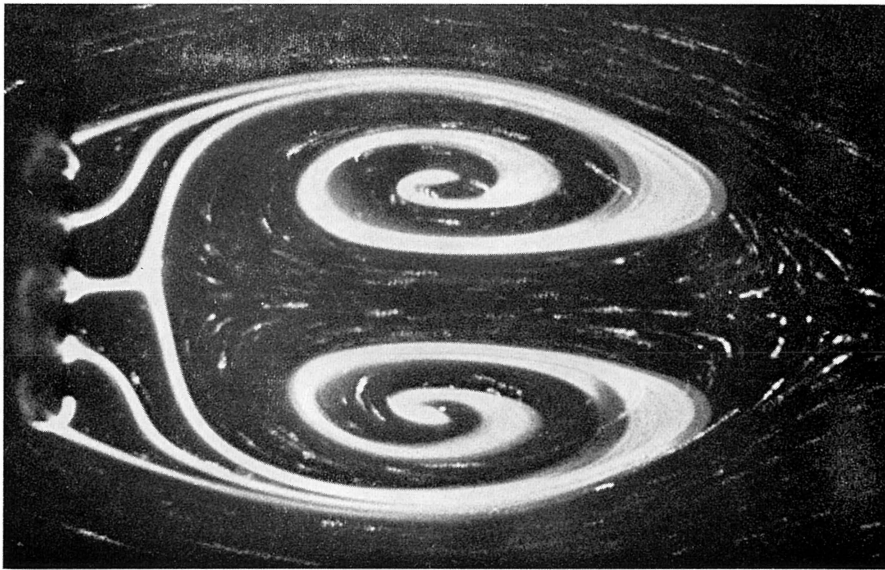
写真 14 電解色素法による出発流れ: d=1.40 cm, d_o=0.200 cm, l/d_o=0.500 , U=1.00 cm/sec, R_s=21.4 , R_g=150 , t=6.80 sec, Ut/d=4.86
