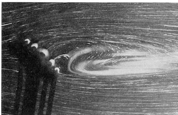
写真 9 46°傾いた円柱列のまわりの定常流: d=1.80 cm, d_0=0.200 cm, l/d_0=1.00 , U=0.272 cm/sec, R_s=5.91 , R_g=53.2
