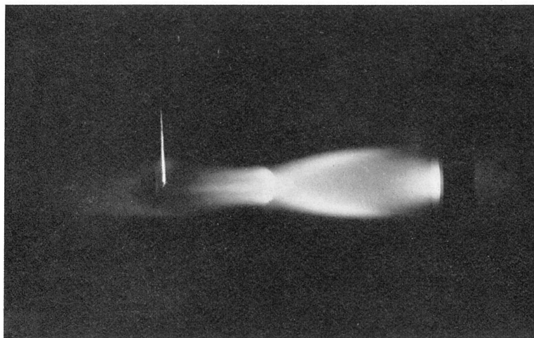
写真 9 ピトー圧測定時の流れ写真
