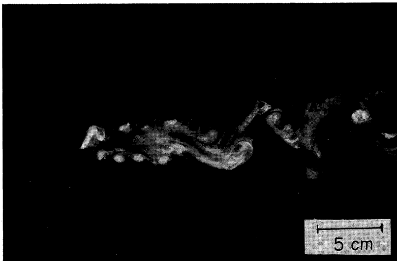
写 真 8 R=104 , S_c=0.250 , T_c/T_k=0.68 , A/d=2.28 , U_0=1.89\text{cm/s} , d=0.50\text{cm} , T_c=1.06\text{s}
